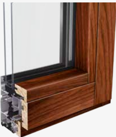
Linea retta - giunto a 90° con fermavetro Squared design - 90° joint with glazing bead
