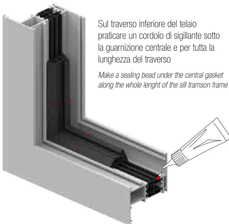
Sul traverso inferiore del telaio praticare un cordolo di sigillante sotto la guarnizione centrale e per tutta la lunghezza del traverso
